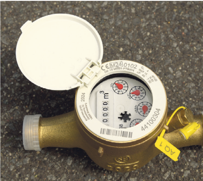
Die Uhr läuft, obwohl kein Wasser verbraucht wird? Dann schnell die Ursache suchen. Sonst kann es teuer werden.
