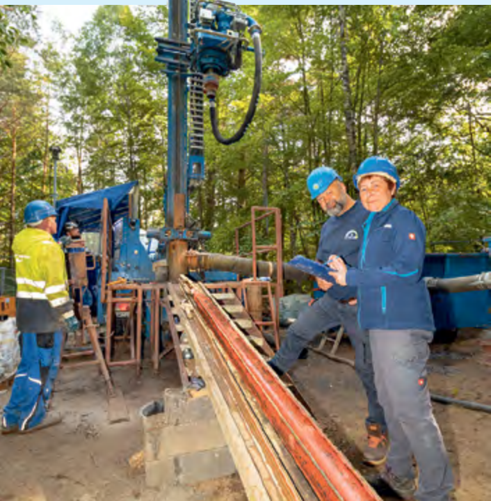
Hydrogeologin Claudia Langer überwacht die Erkundungsbohrung auf der Suche nach einer guten Grundwasserschicht.
