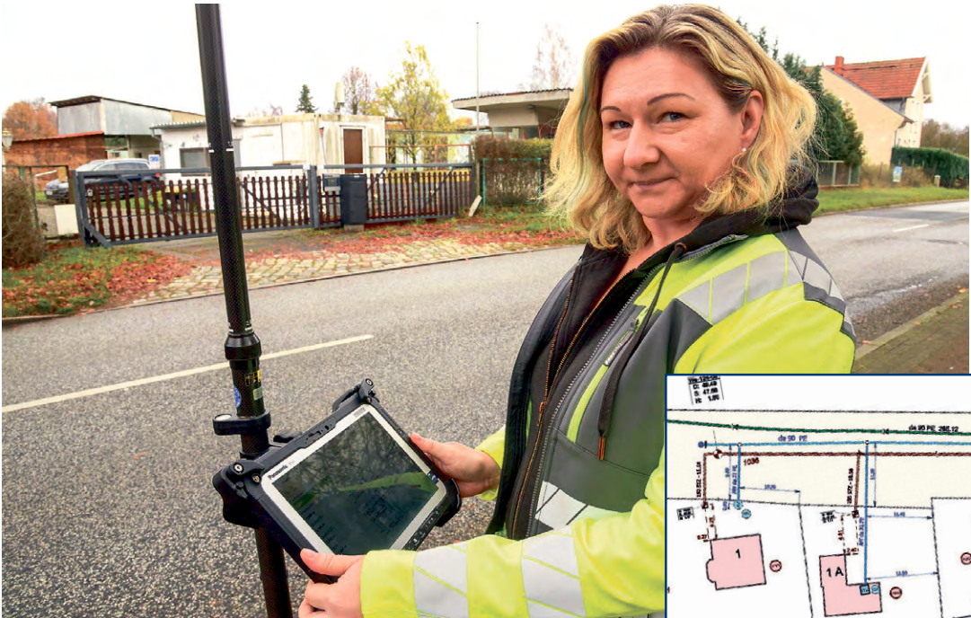
Mit Präzisionsmesstechnik ermittelt Daniela Donner die genaue Lage von Leitungen des NWA. Foto: SPREE-PR/Krone
